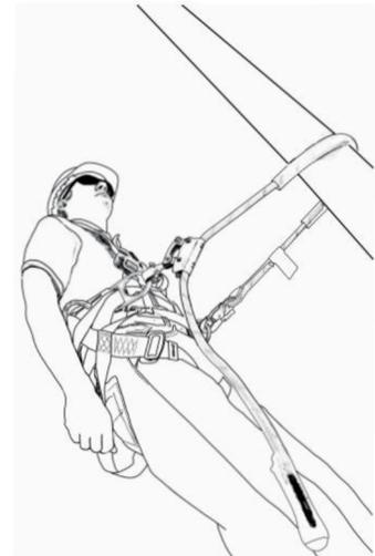
El cabo de sujeción Protec está recomendado sólo para funciones de posicionamiento y no debe utilizarse, bajo ninguna circunstancia, como elemento anticaídas.
